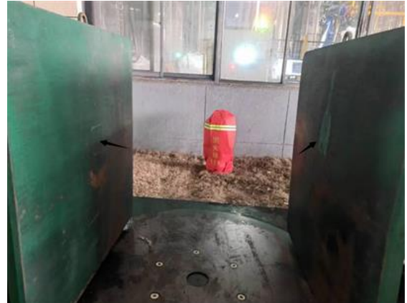
图 3 空心方钢受挤压弹出的擦痕
